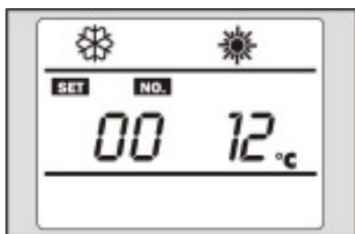
Parameter 00: Soll-Wassereintrittstemperatur im Kühlmodus (8-28°C) Standart 12 °C
